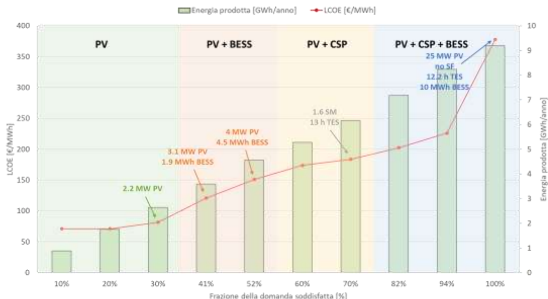
Figura 15: Andamento dell'LCOE e dell'energia annualmente prodotta dall'impianto in funzione della frazione di domanda soddisfatta, per il caso ORC a domanda costante (caso #4).
