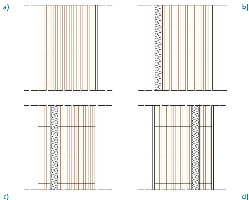
Figura 14. Stratigrafie di alcune pareti in laterizio. a) Parete monostrato; b) parete multistrato con cappotto esterno; c) parete multistrato con isolante in intercapedine (con rifodera esterna); d) parete multistrato con isolante in intercapedine (con rifodera interna)
