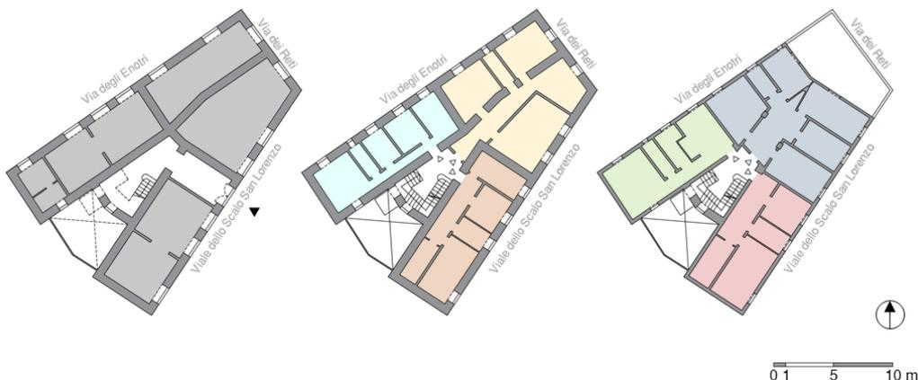
Figura 72. Piante del piano terra, piani 1-4 (pianta tipo) e piani 5/6 (pianta tipo).
