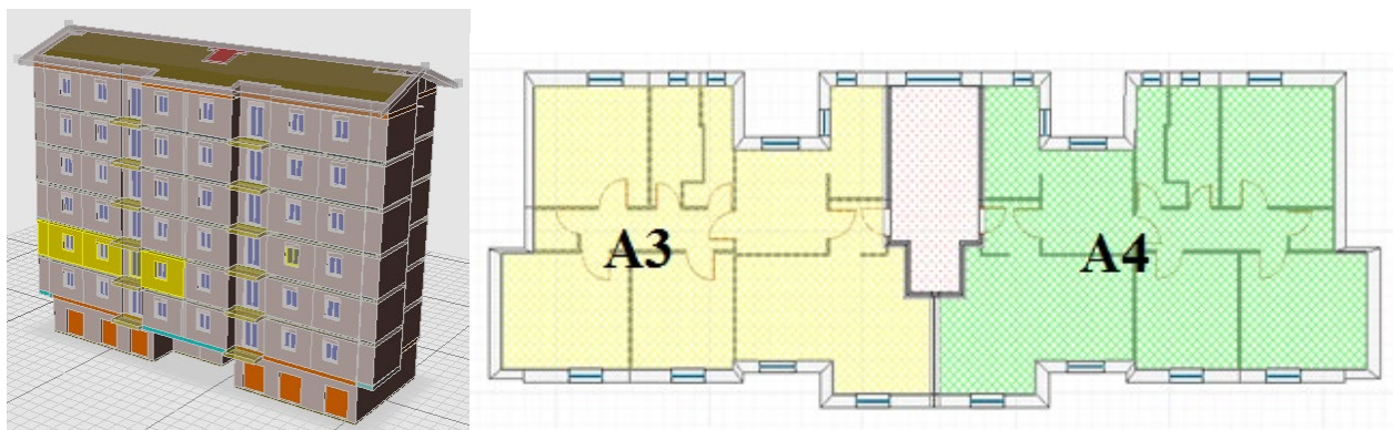
Figura 158: Appartamento distaccato (giallo) dall'impianto termico centralizzato e non riscaldato (A3) – appartamento riscaldato confinante (A4) sullo stesso piano.- Caso studio condominio in provincia di Frosinone
