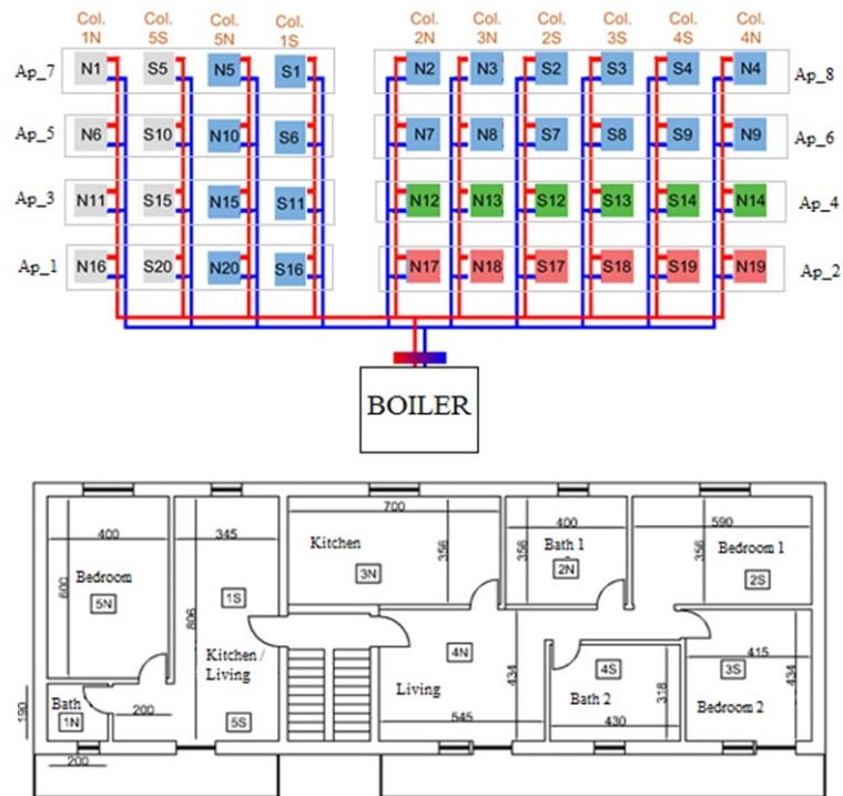
Figura 34 - Set-up sperimentale e corrispondente edificio virtuale
