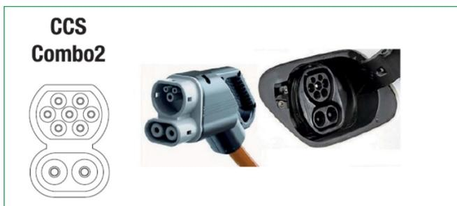
Figura 33: Connettore di ricarica CCS Combo2
