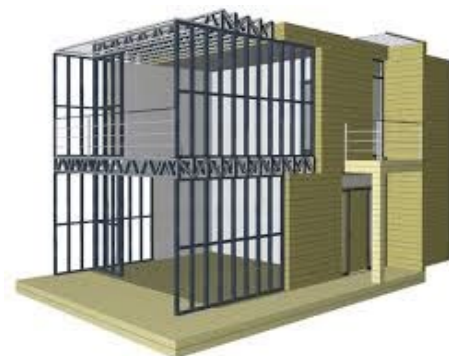
Fig. 6: Tipologia di pareti: a) blocchi alveolati in cemento; b) blocchi forati in laterizio; c) pareti in pannelli prefabbricati per abitazioni; d) pannelli per pareti di capannoni industriali; e) pareti in legno sistema Blockhaus della Rubner; f) pareti in calcecanapa® gettate in opera o pareti in blocchi; g) pareti in profili sottili di acciaio; h) esempi di sagomature di profili sottili di acciaio
