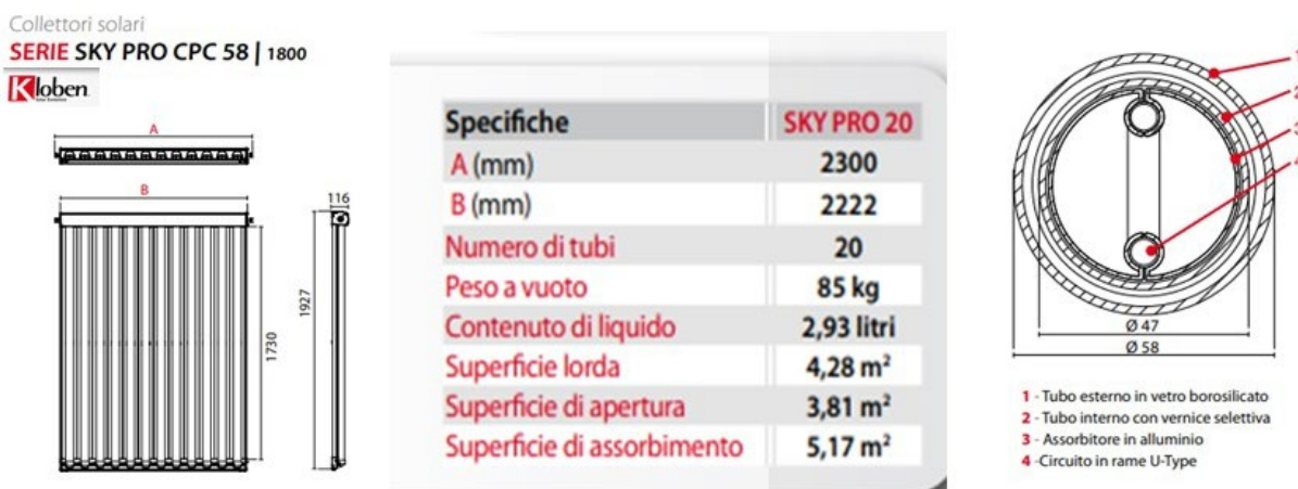
Figura 5. Caratteristiche geometriche e specifiche tecniche dei collettori solari utilizzati nell'impianto di solar cooling presso l'Università di Bari.
