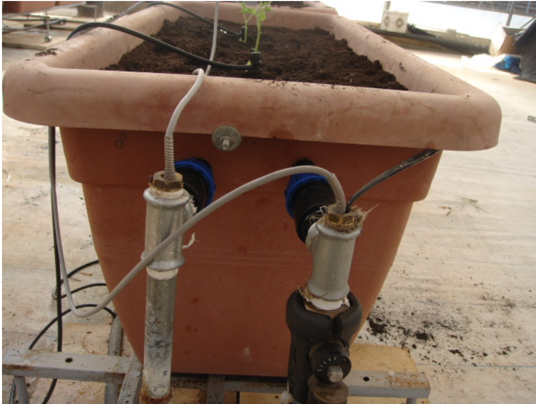
Figura 14. Termistore PT100 per misurare la temperatura dell'acqua che scorre all'interno dei tubi.
