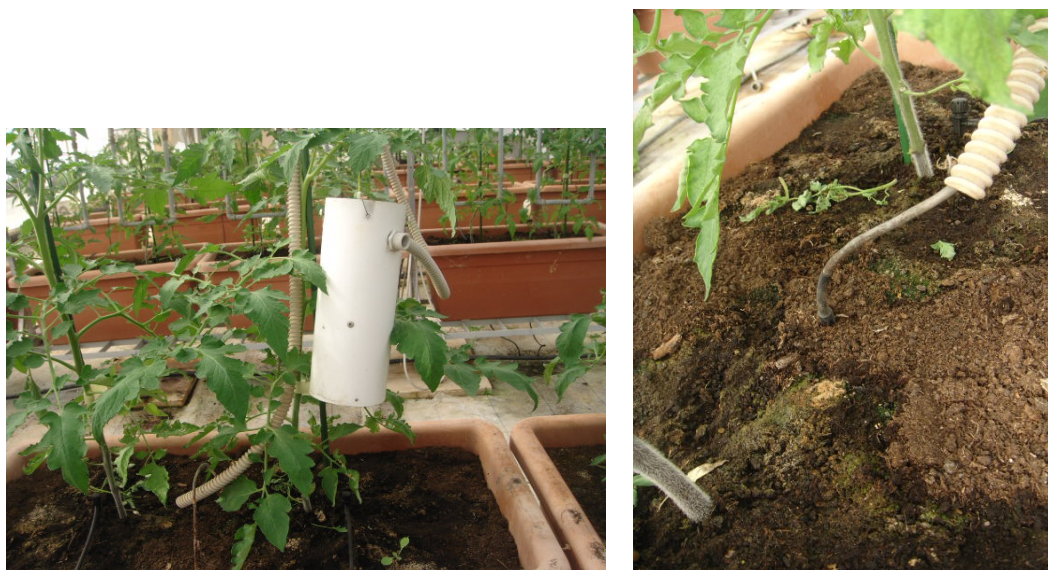
Figura 12. Termistore per la misura della temperatura dell'aria in prossimità delle piante.
