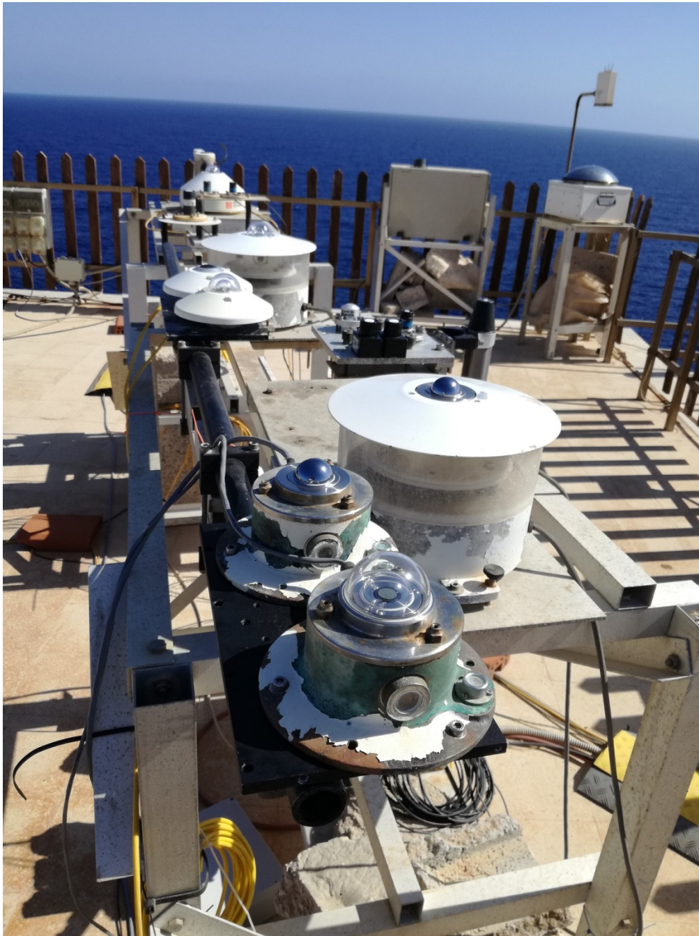
Figura 5.5. Radiometri solari, UV, PAR, ed infrarossi sul tetto dell'Osservatorio Climatico di Lampedusa a luglio 2019
