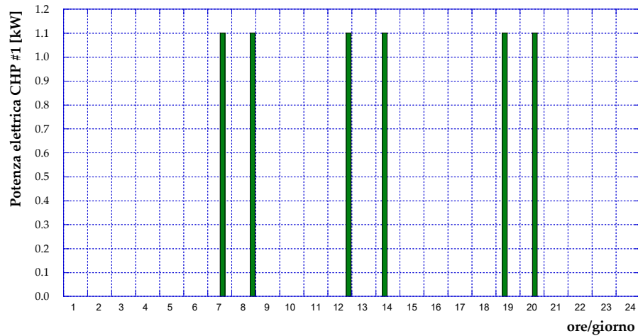
Figura 32 – Profilo di potenza elettrica prodotta dal cogeneratore CHP #1 (22/03/2018).
