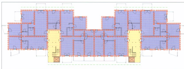
Figura 33. Complesso COSBAU a L'Aquila: pianta con individuazione degli elementi strutturali e vista tridimensionale d'insieme tratti da [26].
