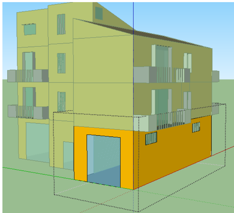
Figura 27: Zona termica 1 (Garage A)
