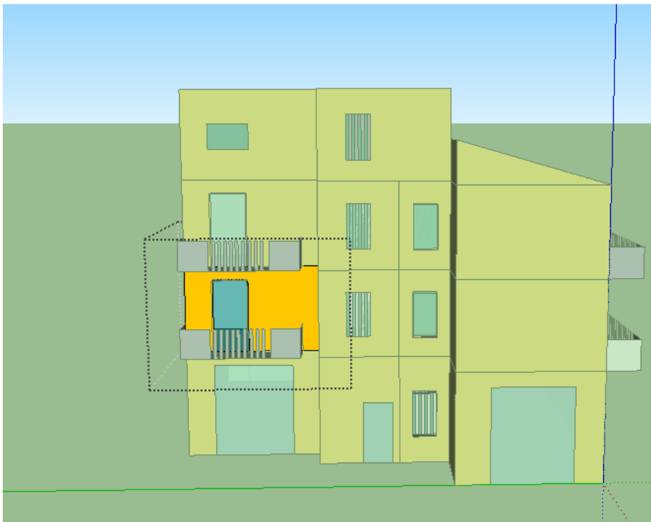
Figura 35: Zona termica 9 (Camera B)
