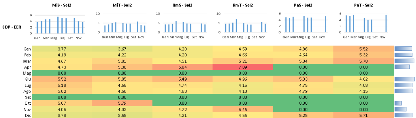
COP/EER con pompa di calore invertibile
