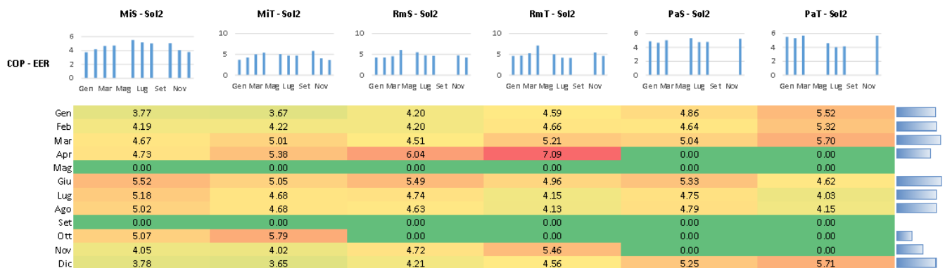
Figura 96: COP/EER con pompa di calore invertibile
