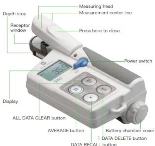
**Figura 30. Misuratore di clorofilla portatile SPAD-502 (Konica Minolta)**
