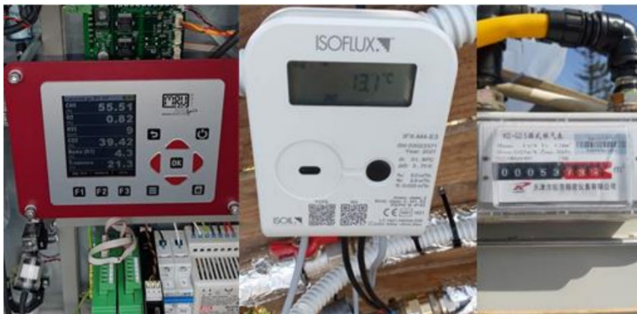
Figura 4-15: da sinistra: analizzatore di biogas, misuratore energia termica a ultra suoni, misuratore volumetrico biogas
