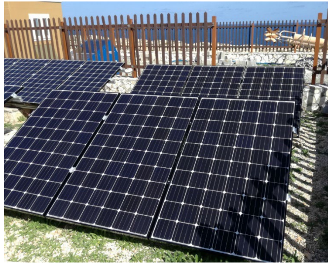
Figura 7-2: Impianto per lo studio dell'effetto della deposizione sulla produzione dei pannelli fotovoltaici
