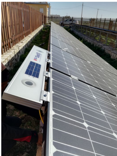
Figura 7-1: Sistema per la misura del soiling, Kipp & Zonen DustIQ, installato presso l'Osservatorio Climatico di Lampedusa
