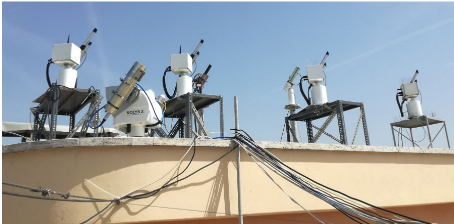
Figura 7-6: Fotometri solari installati sul tetto del Dipartimento di Fisica dell'Università Sapienza durante una campagna di intercalibrazione del 2019
