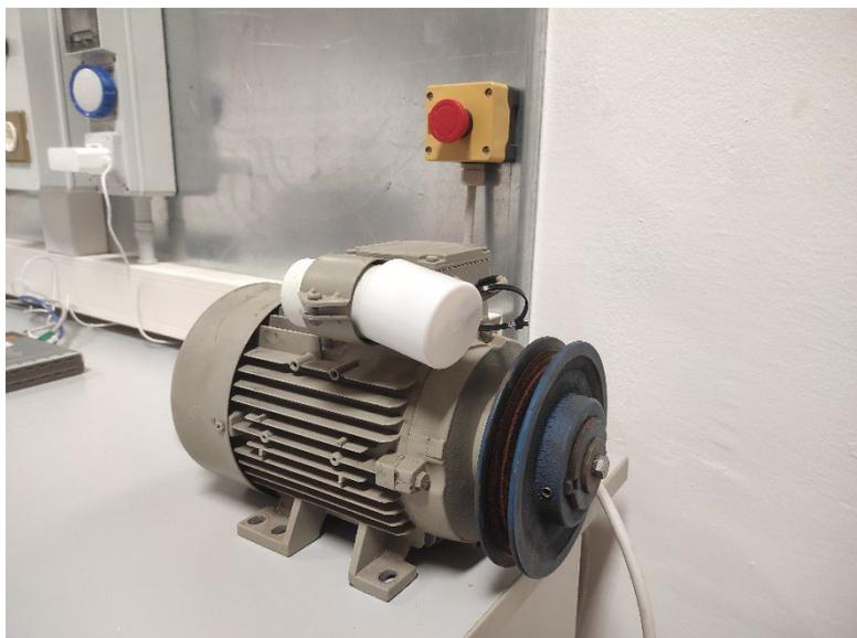
Figura 72. Motore asincrono monofase.
