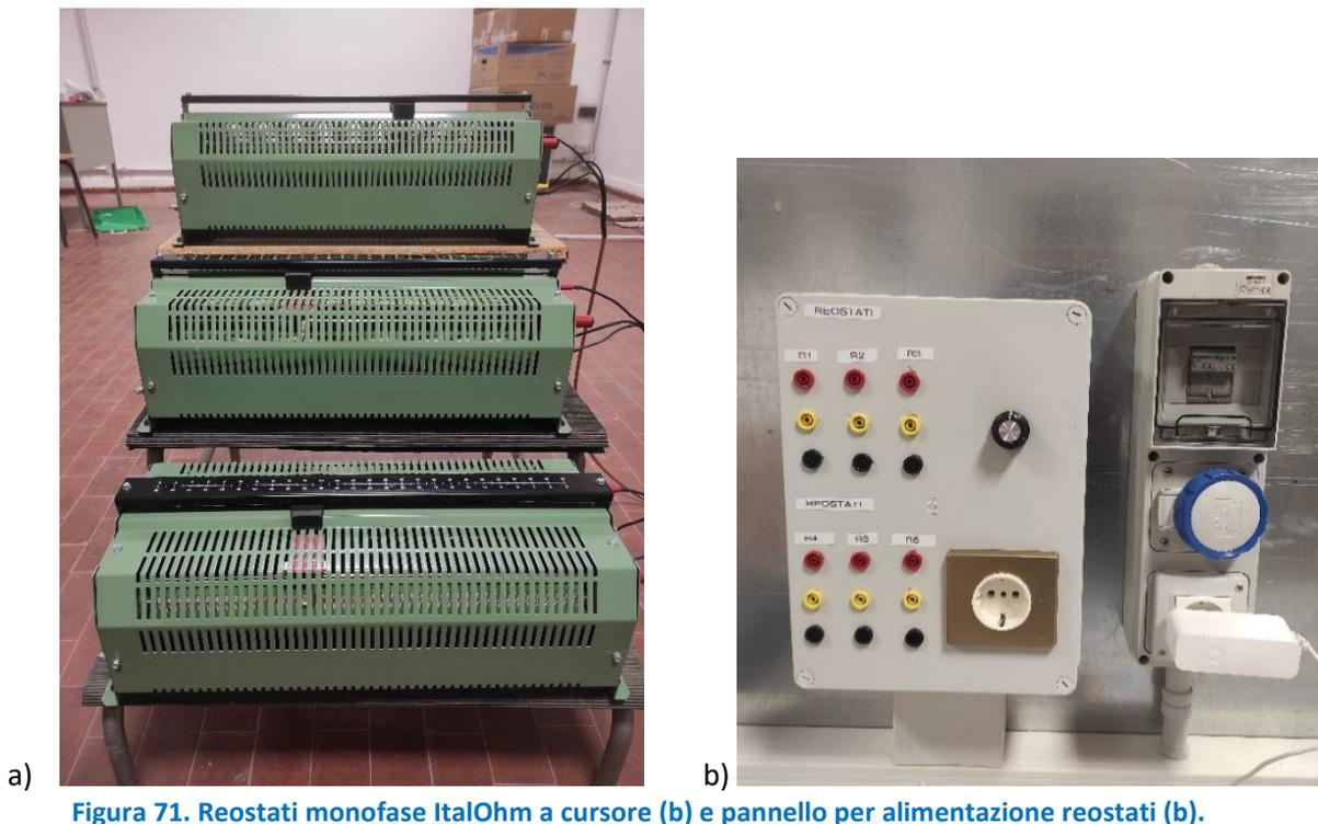
Figura 71. Reostati monofase ItalOhm a cursore (a) e pannello per alimentazione reostati (b).
