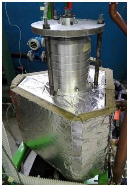
**Figura 44** – Foto dell'espansore del sistema ORC installato presso il Laboratorio di Tecnologie di Microgenerazione dell'Alma Mater Studiorum Università di Bologna [10].
