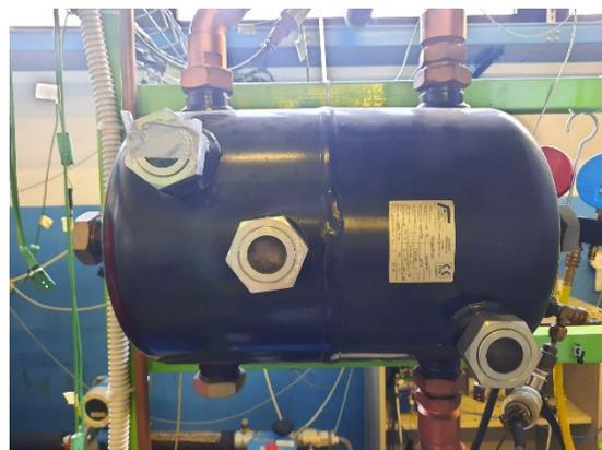
**Figura 47** – Fotografia del ricevitore di liquido.
