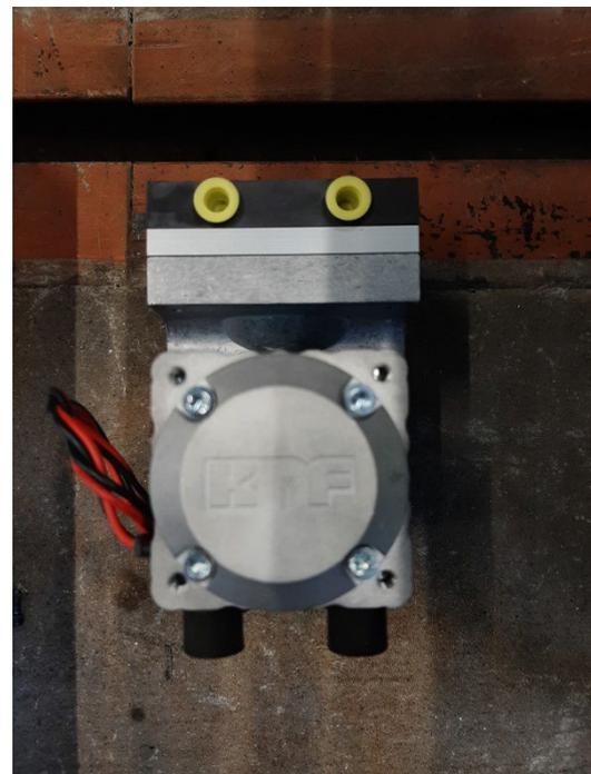
**Figura 41** – Foto del compressore per biogas.
