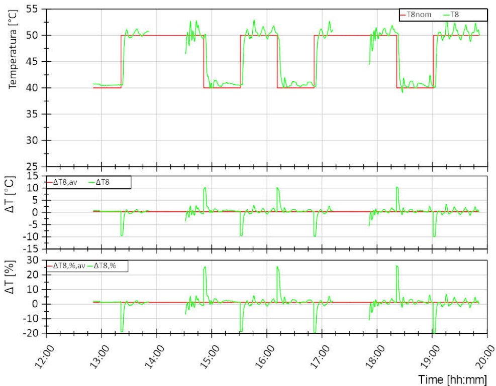
Figura 5.96. Prova dinamica 4. Andamento della temperatura di ritorno dall’utenza T8 (curva verde, grafico superiore) e differenza rispetto al valore di riferimento T8nom in termini assoluti (curva verde, grafico intermedio) e percentuali (curva verde, grafico inferiore). Per ogni grandezza nei grafici sono riportati i valori medi di tutta la prova in rosso.
