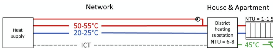
Figura 5.157. Schema di un sistema di rete di TLR di quarta generazione con rete a tre tubi e specifiche riguardanti sottostazioni e radiatori [44]
