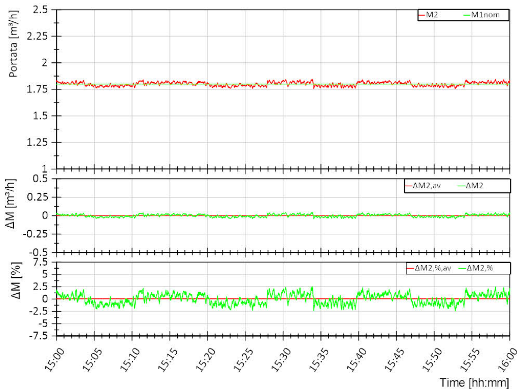
Figura 5.25. Scenario 1, richiesta utenza massima. Andamento della portata del circuito teleriscaldamento M2 (curva verde, grafico superiore) e differenza rispetto al valore di riferimento M1nom in termini assoluti (curva verde, grafico intermedio) e percentuali (curva verde, grafico inferiore). Per ogni grandezza nei grafici sono riportati i valori medi di tutta la prova in rosso.
