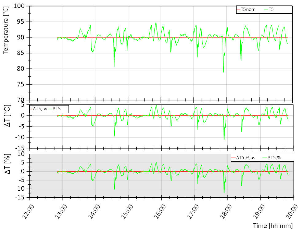
Figura 5.100. Prova dinamica 4. Andamento della temperatura di mandata dal sistema di generazione T5 (curva verde, grafico superiore) e differenza rispetto al valore di riferimento T5nom in termini assoluti (curva verde, grafico intermedio) e percentuali (curva verde, grafico inferiore). Per ogni grandezza nei grafici sono riportati i valori medi di tutta la prova in rosso.
