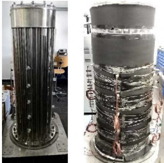
Figura 4. Serbatoio di accumulo con PCM e mantello in plexiglass con e senza isolamento termico.
