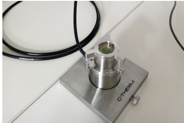
Figura 8. Sensore TCi C-THERM con accessorio per la misura della conducibilità di liquidi o polveri.
