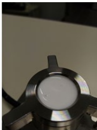
Figura 27. Sensore TCi C-THERM con PCM micro-incapsulato.
