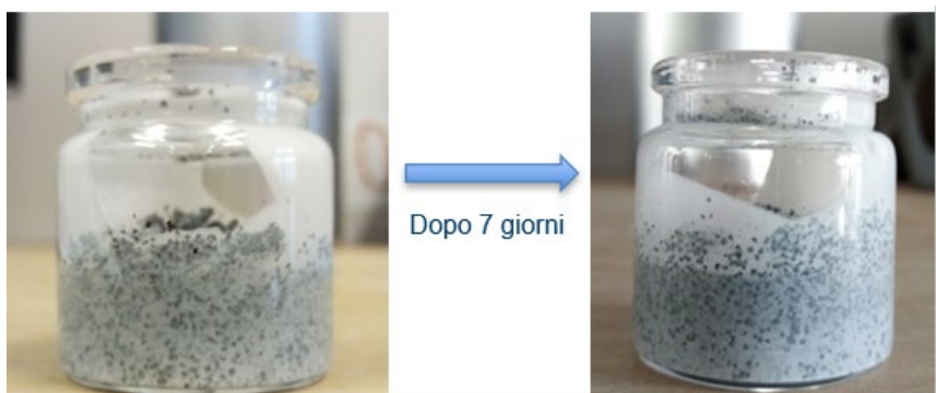
Figura 32. Immagini relative al test per la valutazione della precipitazione della grafite in fiocchi mesh 100 nel PCM micro-incapsulato.
