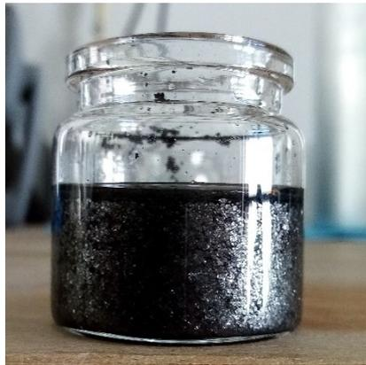
**Figura 3. Composito formato da PCM in fase liquida additivato con fiocchi di grafite ed utilizzato per la validazione del modello numerico sviluppato in questo lavoro.**
