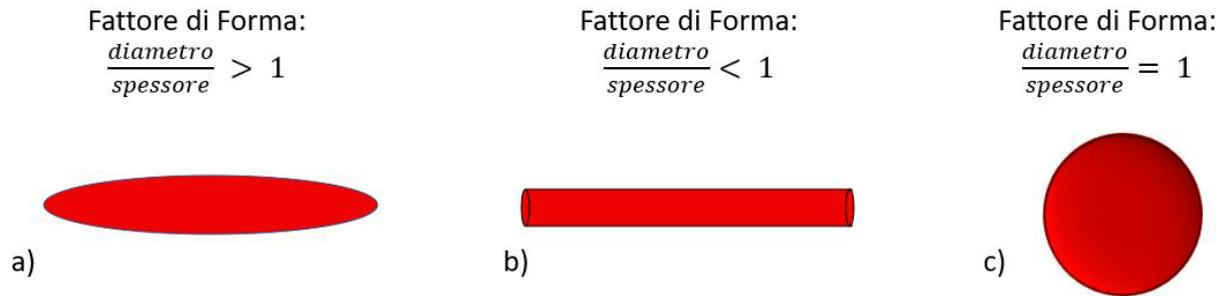
**Figura 6. Fattori di forma nel caso di diversi tipi di inclusioni. a) nano-platelets; b) nanotubi; c) particelle**
