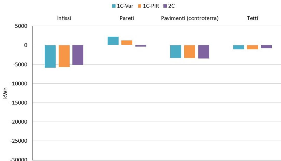
**Figura 74. Edificio ad uso ufficio in zona climatica C - Confronto tra configurazione 1-Var e PIR- e configurazione 2, contributi di involucro al bilancio termico (in kWh totali per la stagione di raffrescamento)**
