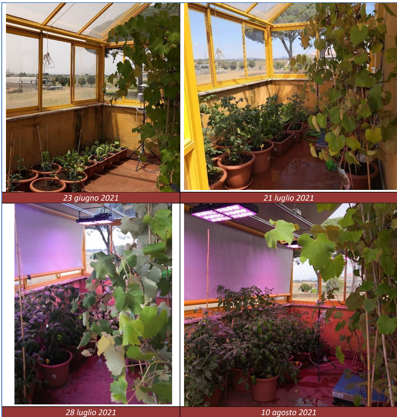
Figura 62. Serra bioclimatica con il “sistema verde” fotografata in diversi momenti di crescita delle piante, prima e dopo l’inserimento del sistema di illuminazione a LED e l’abbassamento delle tende oscuranti.
