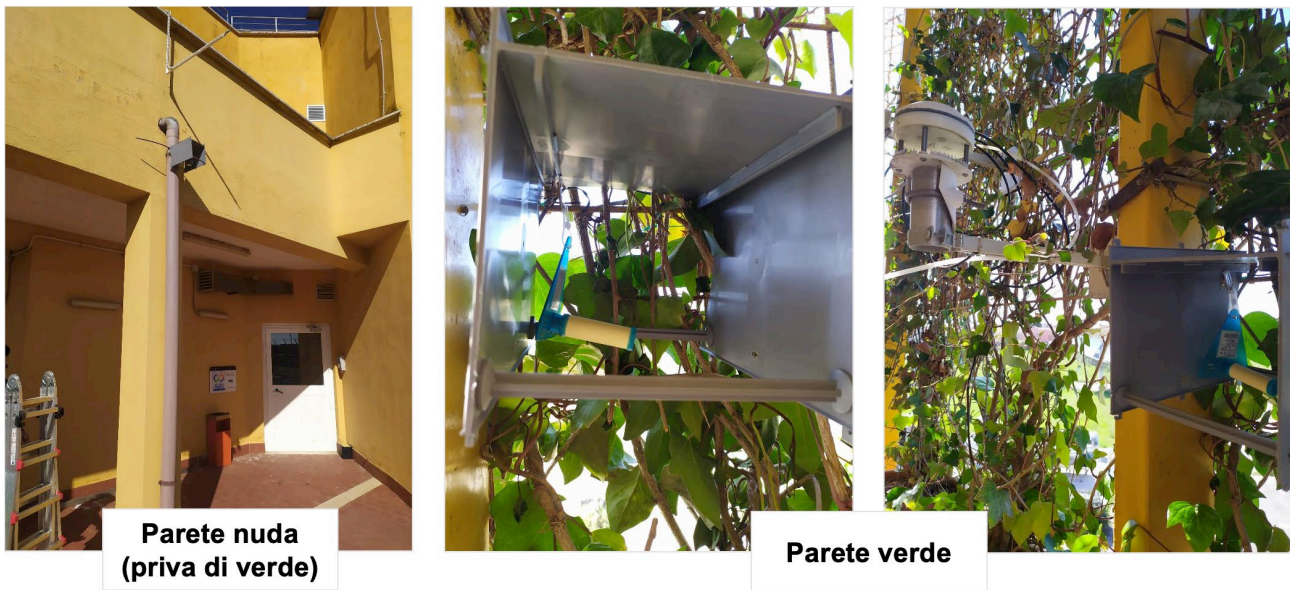
Figura 14. Campionamenti BTEX sulla parete nuda e sulla parete verde tra le foglie presso il CR ENEA Casaccia (inizio primavera 2021).
