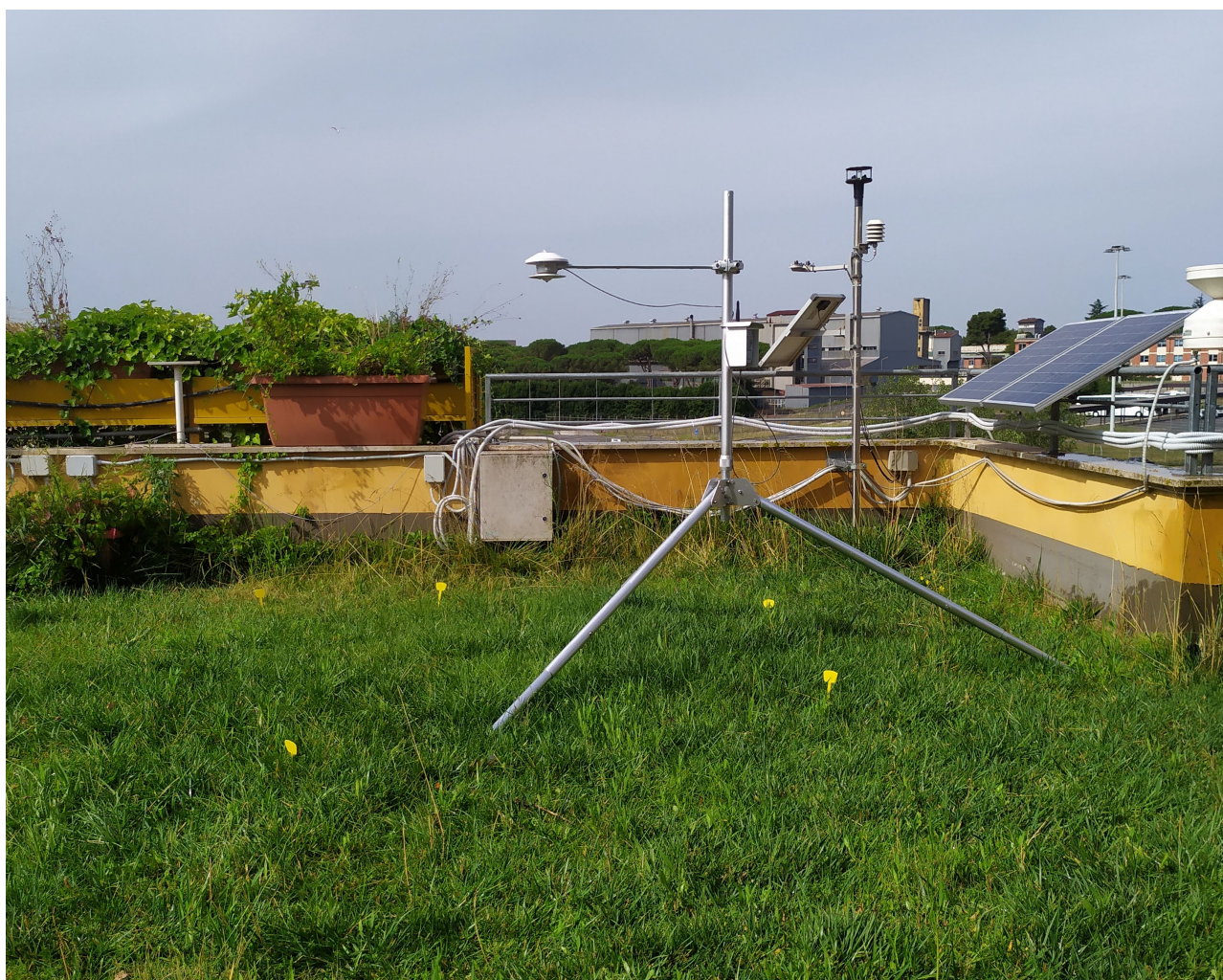
Figura 33. Sito sperimentale dell'analisi dell'albedo in relazione allo spessore del prato, nel settore di prato a graminacee sul tetto verde ENEA (C.R. Casaccia). Le palette gialle sul prato indicano i punti di misurazione dell'altezza delle foglie. Foto del 17 luglio 2021.
