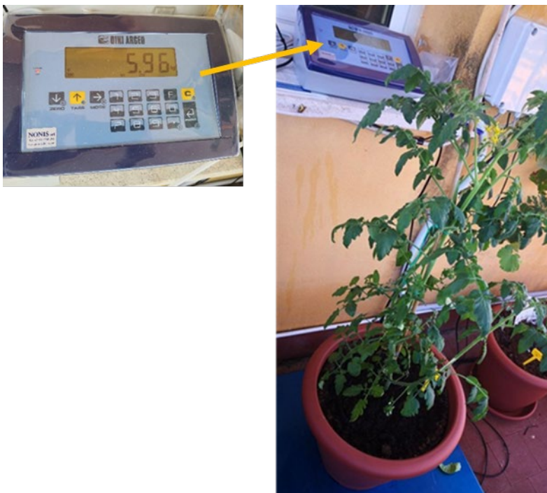
Figura 59. Pianta di pomodoro durante la misura dell'evapotraspirazione. La pianta è posizionata sulla piattaforma (60x60 cm, e portata di 60 Kg (e=5g)) della bilancia a celle di carico e la variazione di peso è visualizzata sull'apposito indicatore (a sinistra).
