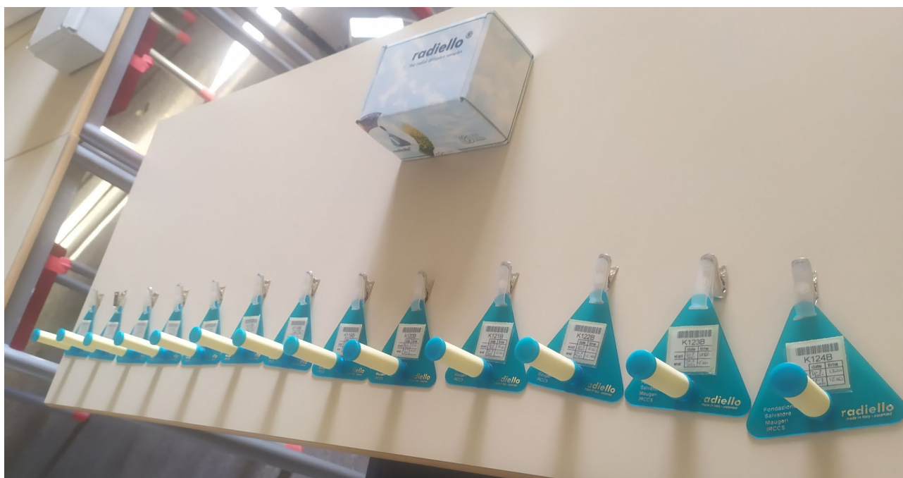
Figura 12. Preparazione dei campionatori di aria a diffusione passiva RADIELLO. Tali dispositivi sono costituiti da una cartuccia adsorbente collocata all'interno del cilindretto giallo, che rappresenta il corpo di diffusione chiuso, supportato da un piatto. Le cartucce sono specifiche per i composti BTEX.
