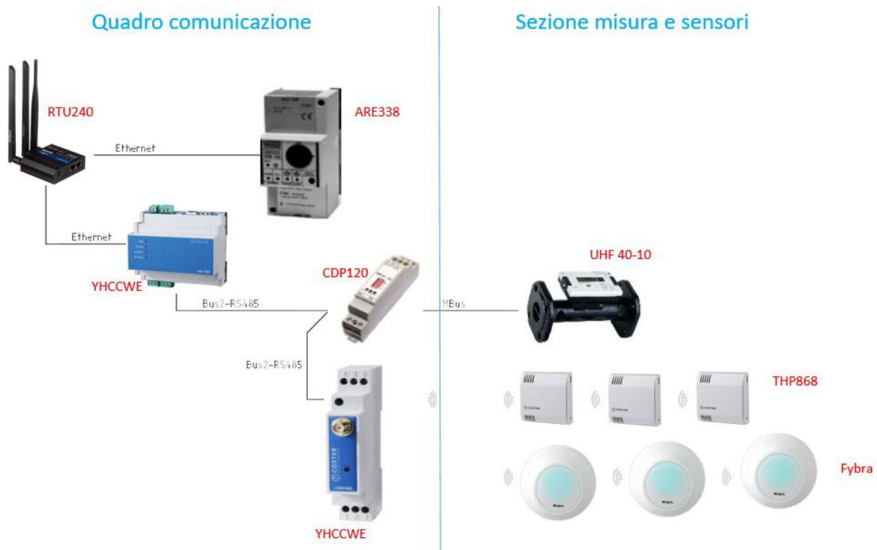
Figura 220: Schema unifilare dei componenti ICT disposti dentro il quadro di comunicazione installato nel locale tecnico del condominio 3.
