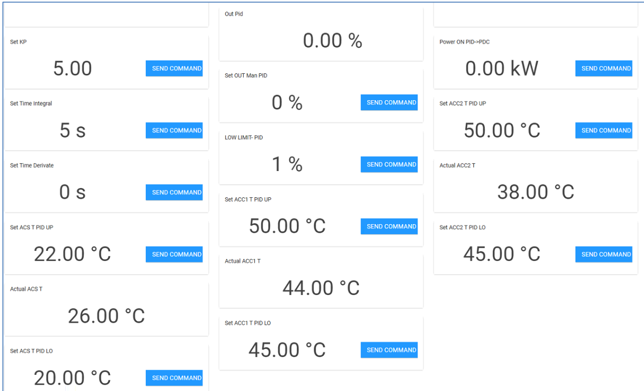
Figura 108: Condizioni termiche iniziali e valori impostati nell'interfaccia PID PDC.
