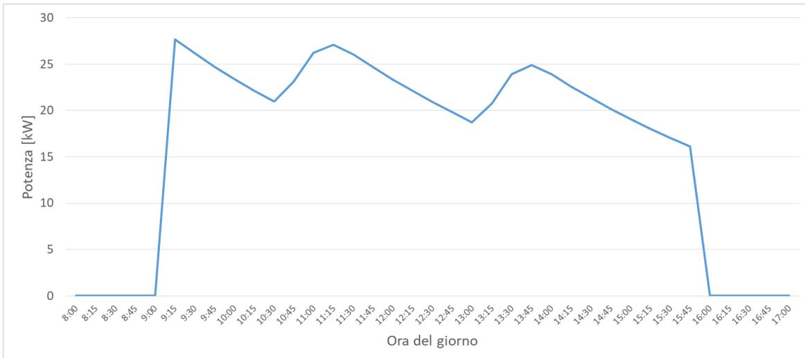
**Figura 27: profilo di carico termico porzione Edificio F83 simulato nelle precedente linea di attività – giorno invernale**
