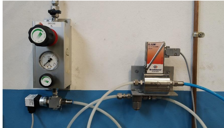
Riduttore di bassa pressione e misuratore di portata con sistema di filtraggio per l'idrogeno
