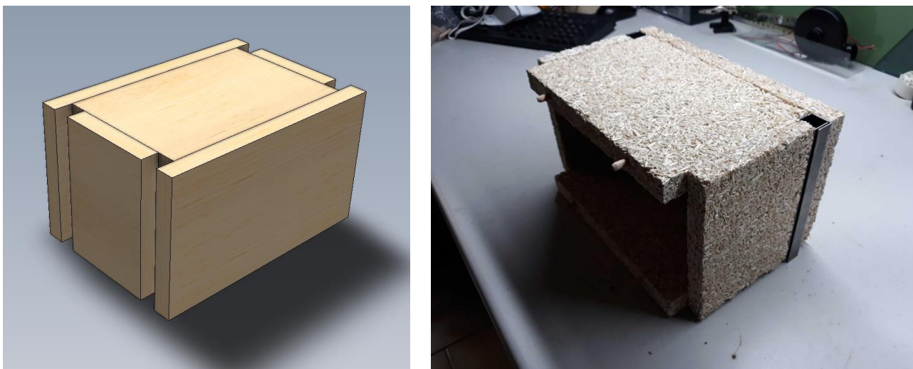
Figura 6: guscio del mattone realizzato con tagli dritti.
