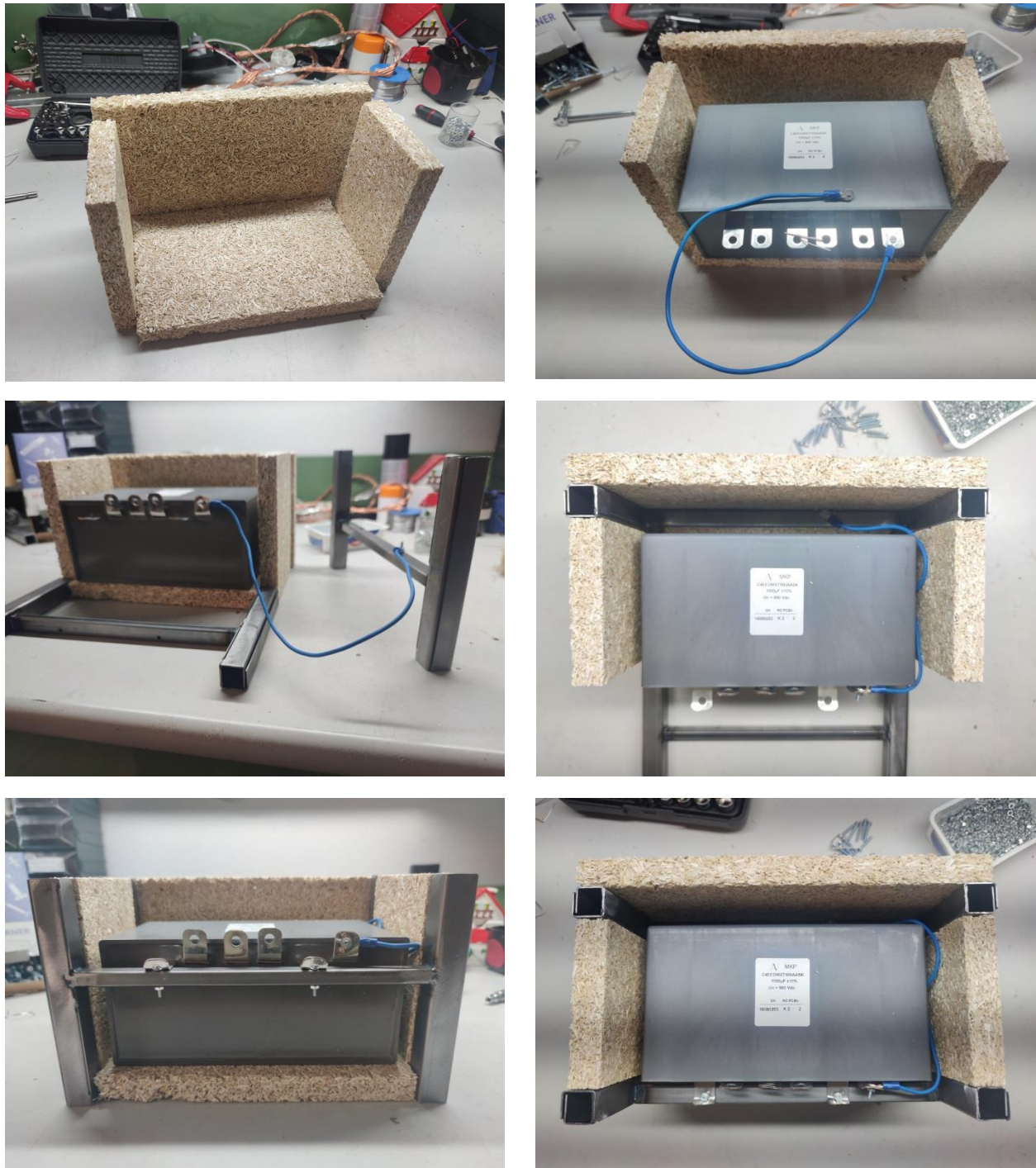
Figura 24: costruzione del guscio a contenere il condensatore.
