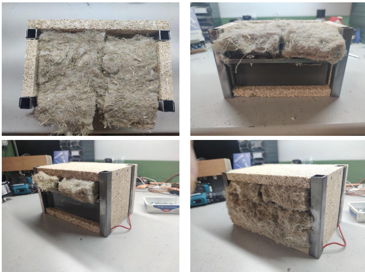
Figura 25: inserimento dell'isolante in fibra di canapa.
