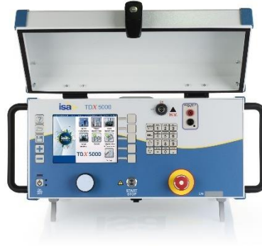
Fig. 5.2: Strumento utilizzato per la misura della capacità e tandelta durante le prove
