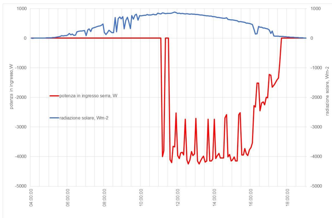
Figura 40. Radiazione solare incidente e potenza di raffreddamento generata nel caso di alimentazione dell'assorbitore solo con i collettori solari.
