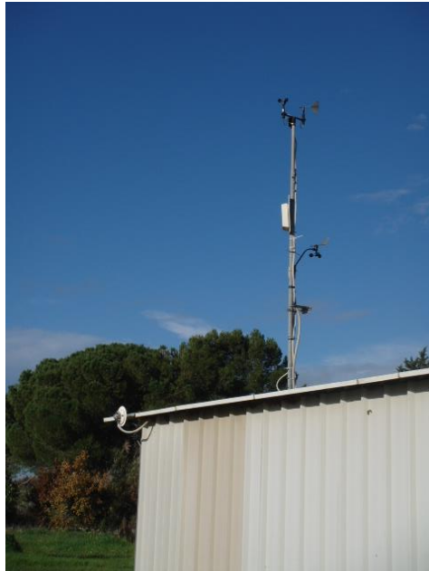
Figura 26. Stazione meteorologica presso l'Università di Bari.
