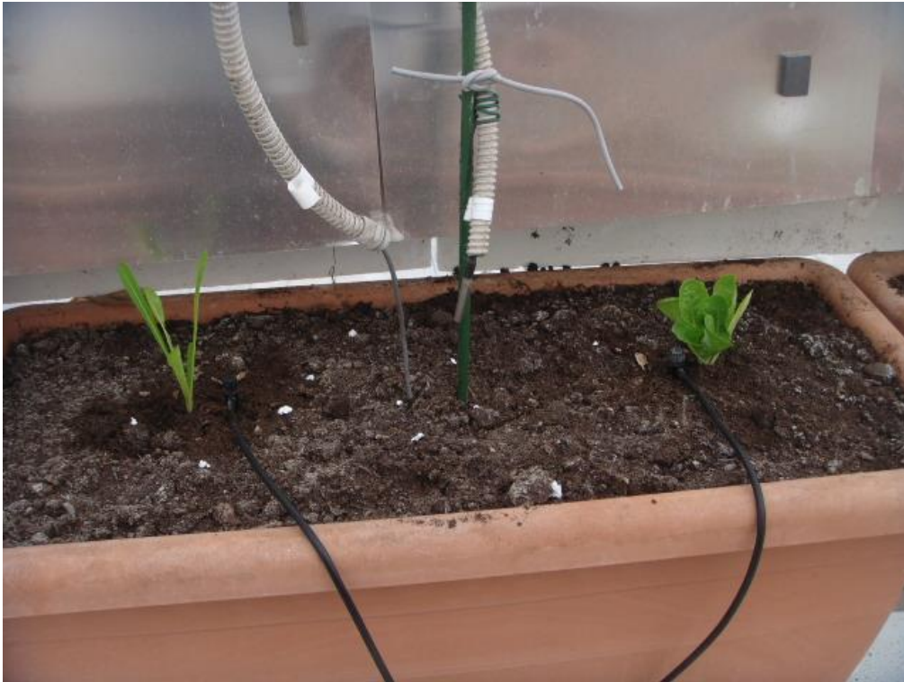
Figura 28. Sensori: Termistore per la misura della temperatura e dell'umidità relativa dell'aria in prossimità delle piante e termistore per la misura della temperatura del substrato di coltivazione.
