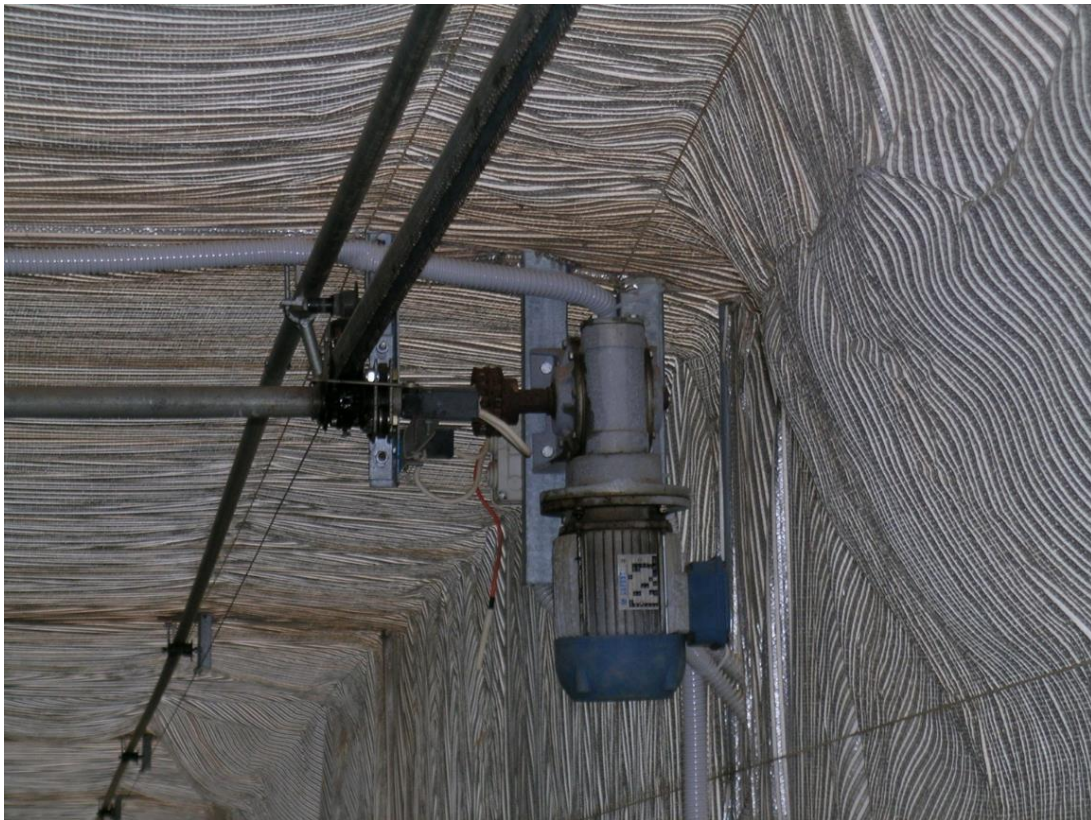
Figura 64. Schermo termico mobile utilizzato presso il campo sperimentale dell'Università di Bari
