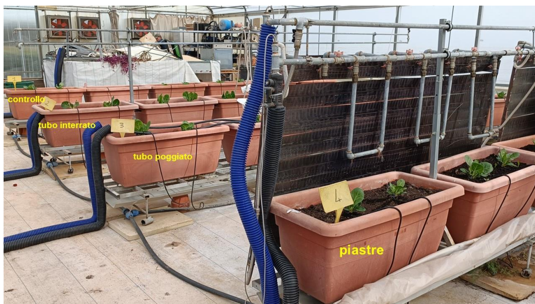
Figura 23. Tre sistemi di distribuzione del freddo/caldo in prossimità delle piante testati durante il 2021 e il controllo (senza condizionamento localizzato) all'interno della serra presso l'Università di Bari.
