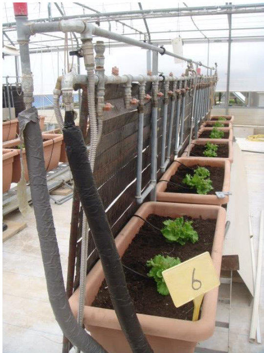
Figura 24. Sistema di distribuzione del freddo/caldo denominato “piastre”.
