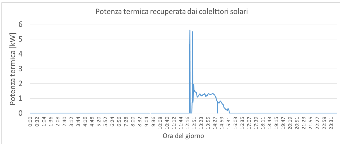
Figura 120: Potenza termica recuperata dal raffreddamento dei moduli fototermici – circolatore solare attivato alle 12.30 circa
