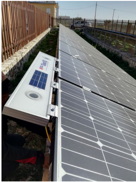
Figura 173: Sistema per la misura del soiling, Kipp & Zonen DustIQ, installato presso l'Osservatorio Climatico di Lampedusa
