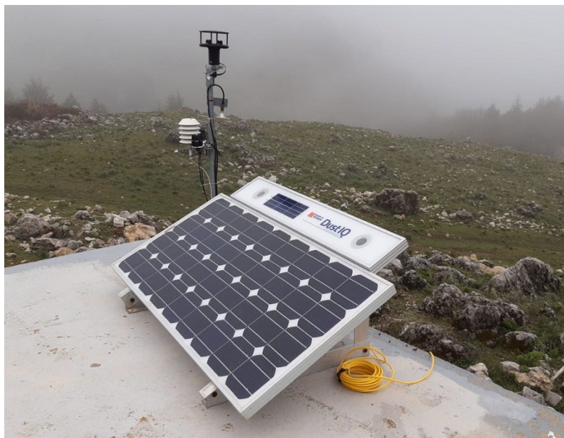
Figura 192: Prima installazione del sensore DustIQ con un pannello di piccole dimensioni presso l'Osservatorio Madonie-Piano Battaglia ad aprile 2021. Dietro il pannello c'è il palo con anemometro sonico e sensori meteorologici
