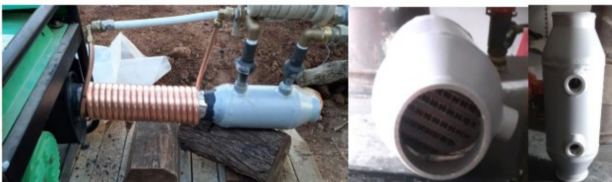
Figura 126: Rappresentazioni di dettaglio dello scambiatore di calore per il recupero energetico sui gas di scarico del motore a combustione interna.
