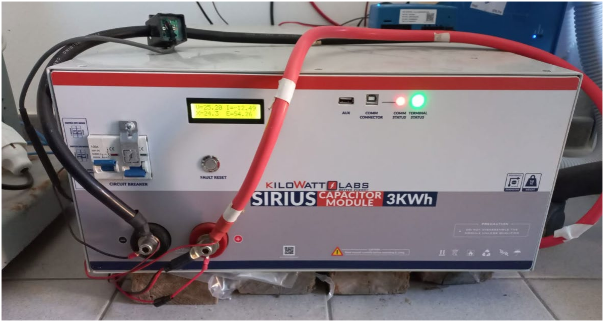
Figura 3: Sistema di supercondensatori da 3 kWh connesso all'impianto sperimentale di Lampedusa
