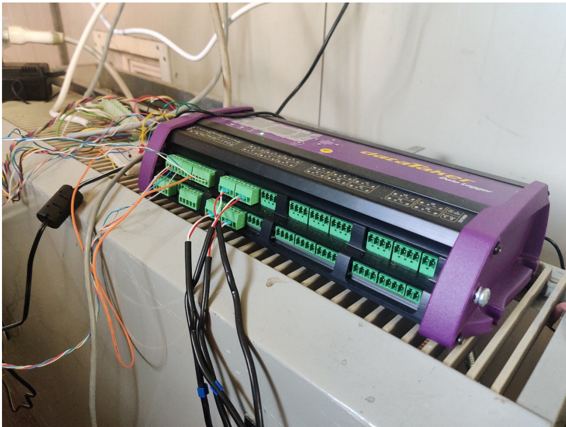
Figura 71: Sistema di test per lo scalda-acqua smart. Dettaglio del datalogger utilizzato per l'acquisizione dati
