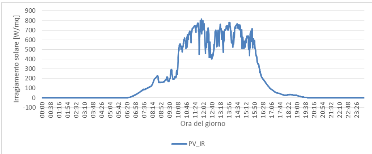
Figura 55: prova con impianto sperimentale – potenza FV installata 580 Wp – andamento dell’irraggiamento solare nel giorno in esame – prova 5
