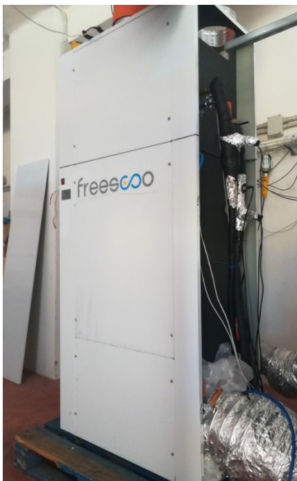
Figura 140. Macchina Freesco VMC in prova presso il laboratorio Solarinvent.
