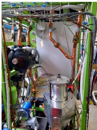
Figura 45 – Foto del banco prova ORC installato presso il Laboratorio di Tecnologie di Micro-generazione dell’Alma Mater Studiorum Università di Bologna.
