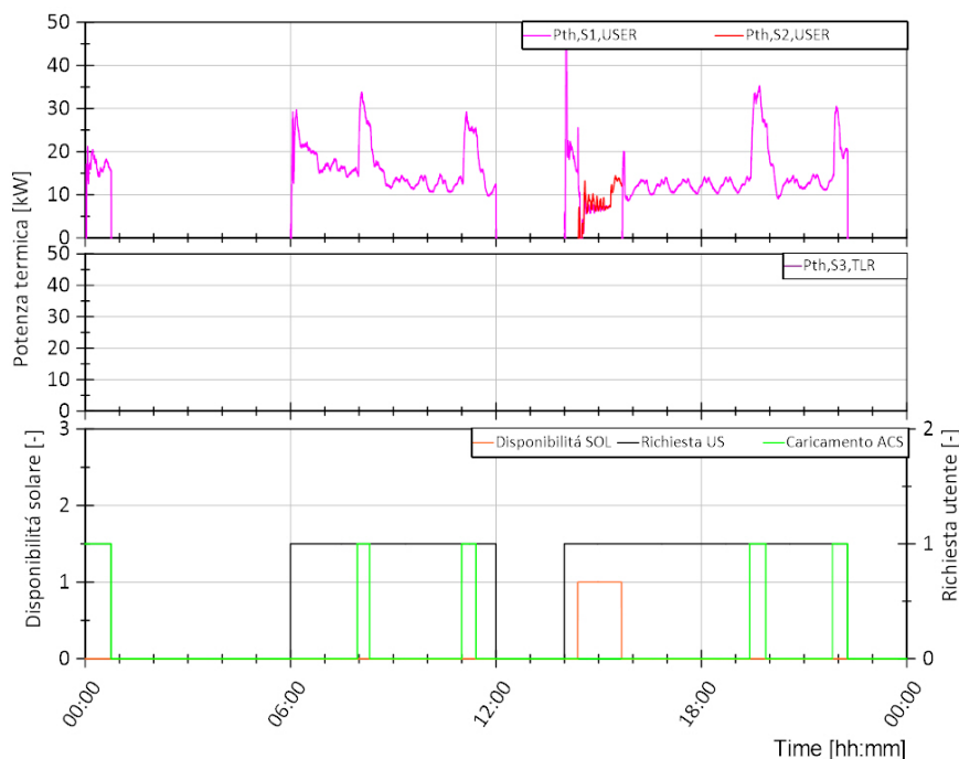
Figura 5.34. Sessione A, Giorno 6. Andamento della potenza termica lato utenza dello scambiatore S1 ed S2 nel grafico superiore e segnale di disponibilità energia solare nell'accumulo (arancione), richiesta termica utente (nero) e richiesta di caricamento accumulo ACS (verde) nel grafico inferiore
