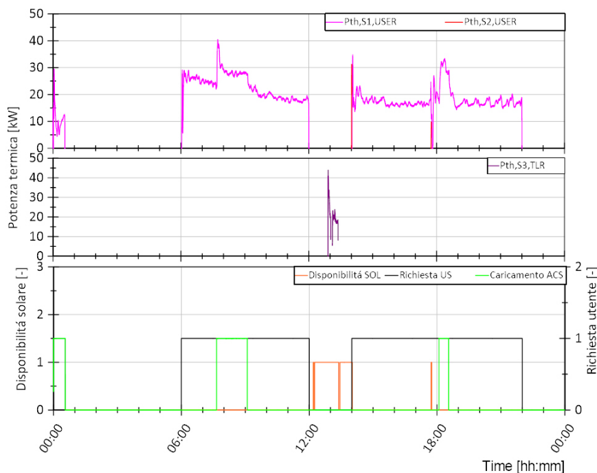
Figura 3.146. Sessione A, Giorno 1. Andamento della potenza termica lato utenza dello scambiatore S1 ed S2 nel grafico superiore, andamento della potenza termica lato TLR dello scambiatore S3 nel grafico centrale e segnale di disponibilità energia solare nell'accumulo (arancione), richiesta termica utente (nero) e richiesta di caricamento accumulo ACS (verde) nel grafico inferiore
