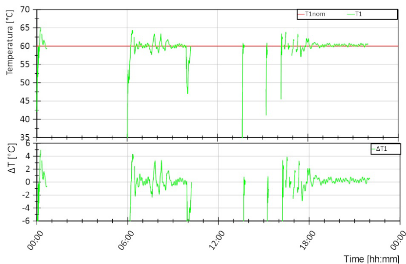
Figura 5.51. Sessione B1, Giorno 2. Andamento della temperatura di mandata dal teleriscaldamento T1 (curva verde, grafico superiore) e differenza rispetto al valore di riferimento T1nom in termini assoluti (curva verde, grafico inferiore)
