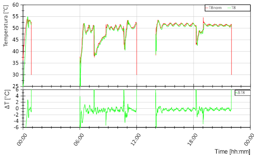
Figura 3.198. Sessione B1, Giorno 1. Andamento della temperatura di ritorno dall'utenza T8 (curva verde, grafico superiore) e differenza rispetto al valore di riferimento T8nom in termini assoluti (curva verde, grafico inferiore)
