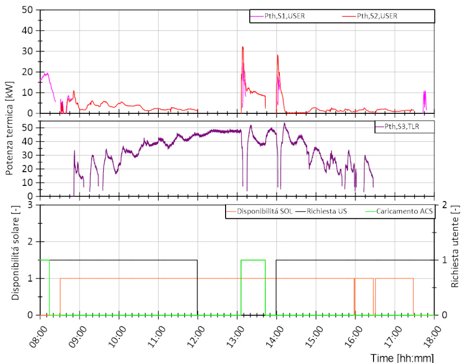
Figura 3.206. Sessione B1, Giorno 3 - Dettaglio. Andamento della potenza termica lato utenza dello scambiatore S1 ed S2 nel grafico superiore, andamento della potenza termica lato TLR dello scambiatore S3 nel grafico centrale e segnale di disponibilità energia solare nell’accumulo (arancione), richiesta termica utente (nero) e richiesta di caricamento accumulo ACS (verde) nel grafico inferiore
