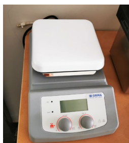
Figura 2. Agitatore magnetico Orma AG5D.
