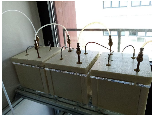
Figura 22. Moduli del condensatore con PCM integrato collegati in serie.
