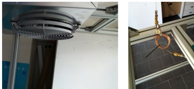
Figura 23. Evaporatore di tipo convenzionale e capillare per la laminazione.
