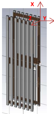
Figura 5: modello della coppia di DD coil, con sistema di riferimento.
