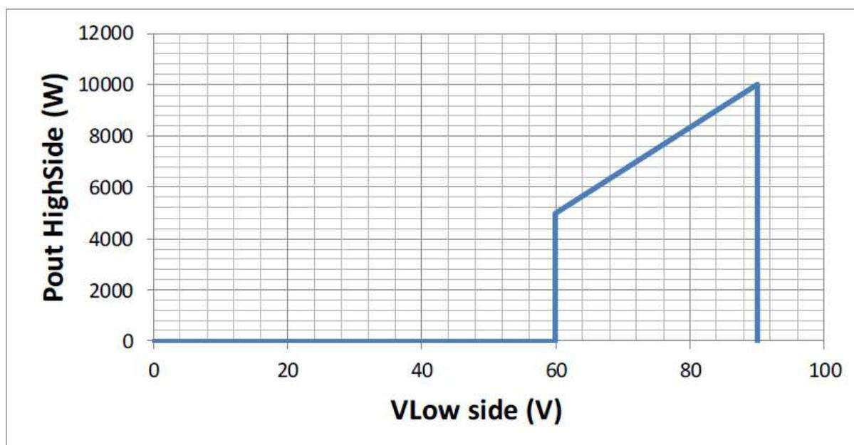
**Figura 25** andamento della potenza massima in uscita dall'inverter in funzione della tensione di uscita
