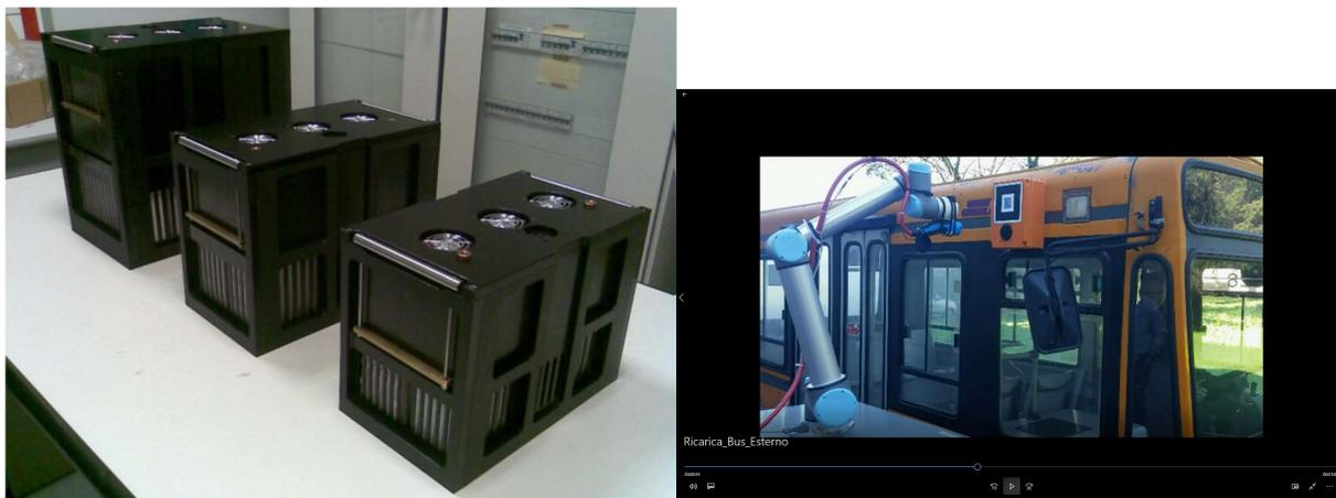
**Figura 1 moduli di batteria LFP con ricarica a 3C e ricarica automatizzata tramite braccio robotizzato.**
