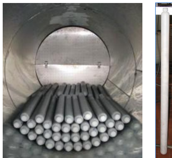
Figura 57 – Serbatoio di accumulo e uno dei contenitori di PCM inseriti in esso.
