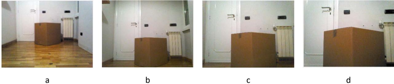
**Figura 43 – Test #3: immagini acquisite dalla telecamera del robot prese a diversa distanza dall'ostacolo: a) 200cm, b) 150cm, c) 100 cm, d) 60 cm**
