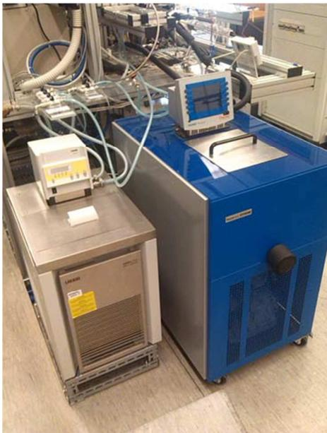
Figura 5. I due bagni termostatici: a sinistra il bagno "Lauda"; a destra il bagno "ThermoHaake".
