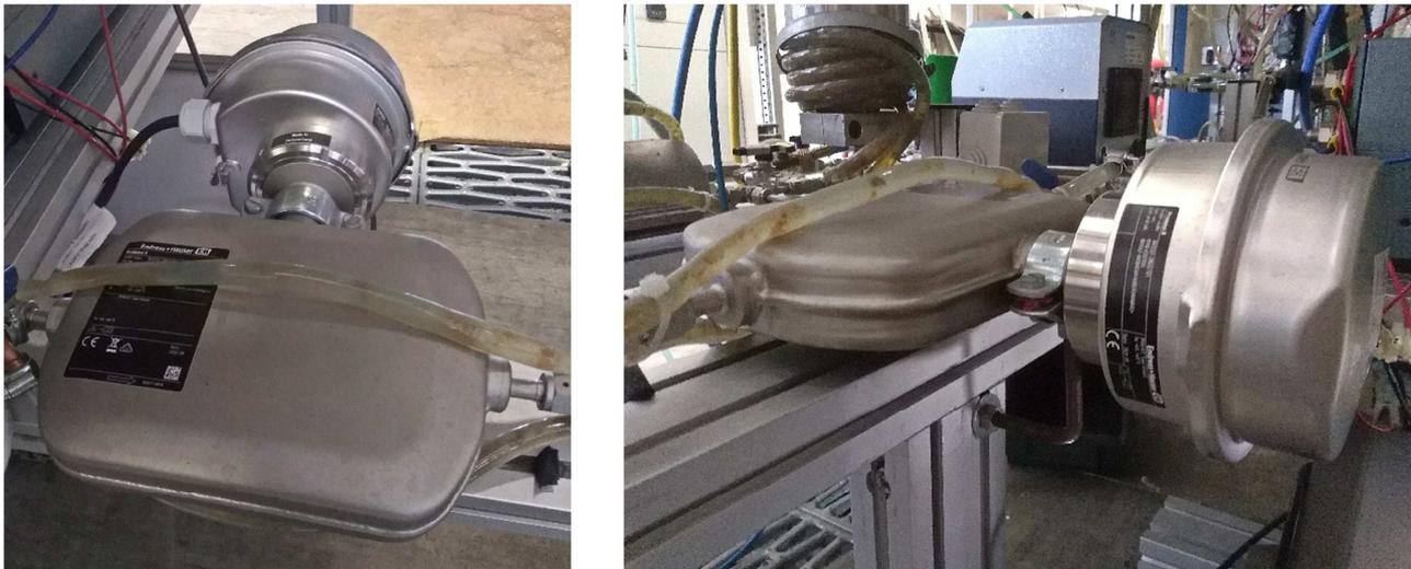
Figura 4. Il nuovo misuratore di portata del refrigerante installato nell'impianto sperimentale.
