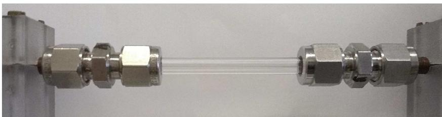
Figura 7. Il tubo in vetro borosilicato inserito nella sezione da 3.38 mm.
