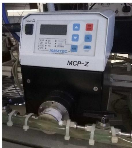
**Figura 3. La pompa del refrigerante.**
