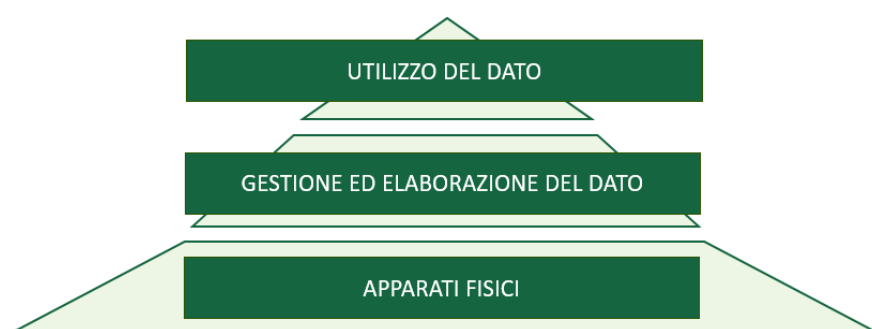
Figura 2 – Architettura digitale per la raccolta, gestione, elaborazione ed utilizzo dei dati di una Smart City
