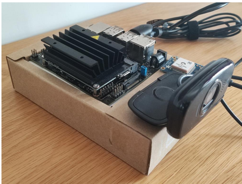
Figura 16. Il sistema di rilevamento del manto stradale, composto dalla scheda Jetson Nano dove gira il SW, una webcam ed il sensore GPS (il quadrato chiaro subito sopra la webcam)
