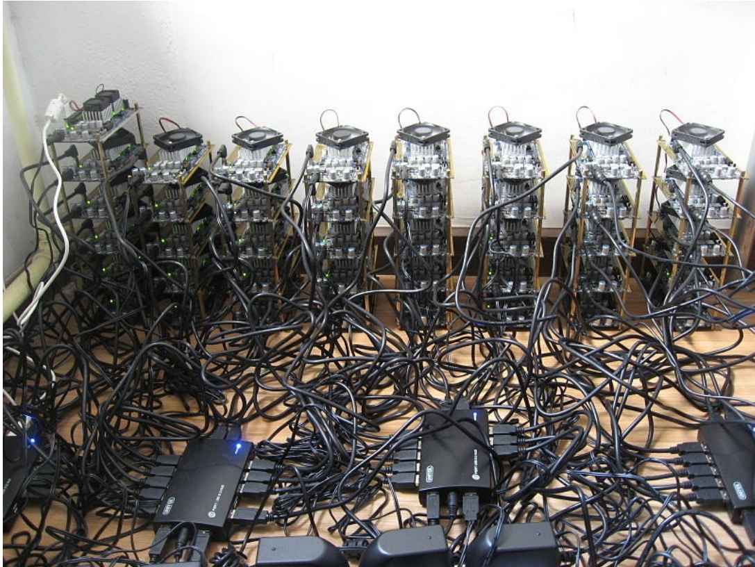
Figura 13: insieme di FPGA, si nota come l'attività di mining Bitcoin inizi ad essere sempre più ingombrante rispetto agli inizi, dove bastava una semplice CPU.
