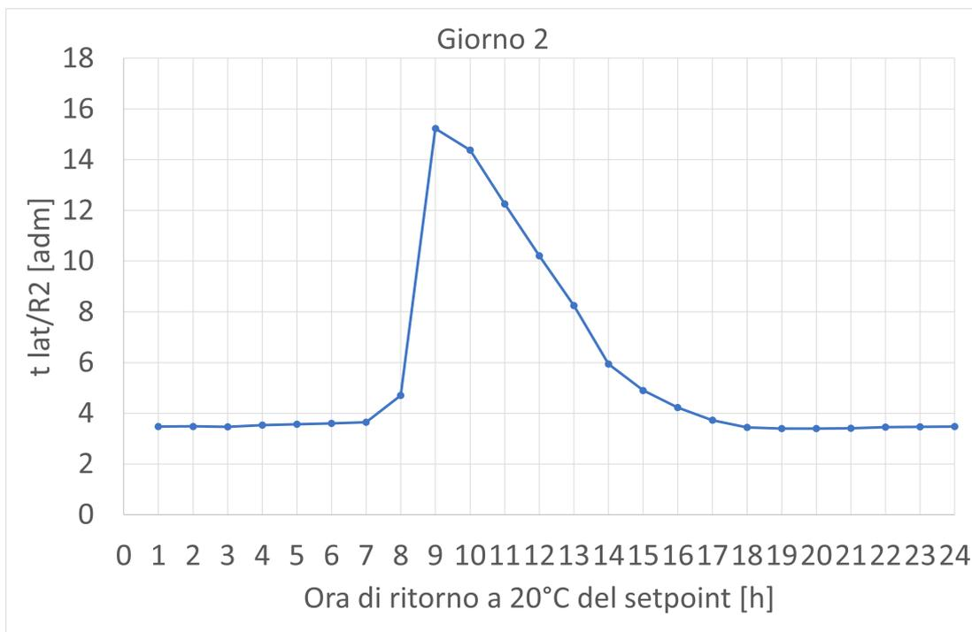
**Fig.46** Valore del rapporto  $R_3$  per il 2°giorno in relazione all'istante di tempo in corrispondenza del quale il valore di setpoint  $T_{sp}$  viene riportato a 20°C.
