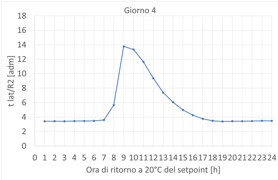
Fig.48 Valore del rapporto  $R_3$  per il 4°giorno in relazione all'istante di tempo in corrispondenza del quale il valore di setpoint  $T_{sp}$  viene riportato a 20°C.
