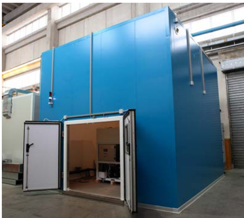
Figura 1 - Camera climatica del CR ENEA Casaccia
