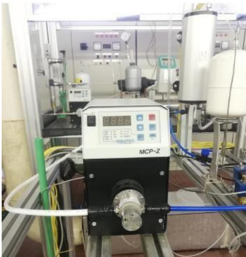
Figura 3. Pompa volumetrica ad ingranaggi
