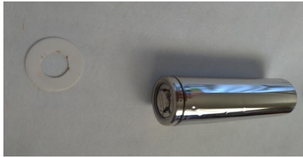
Figura 51 Cella dopo la rimozione del case verde in plastica
