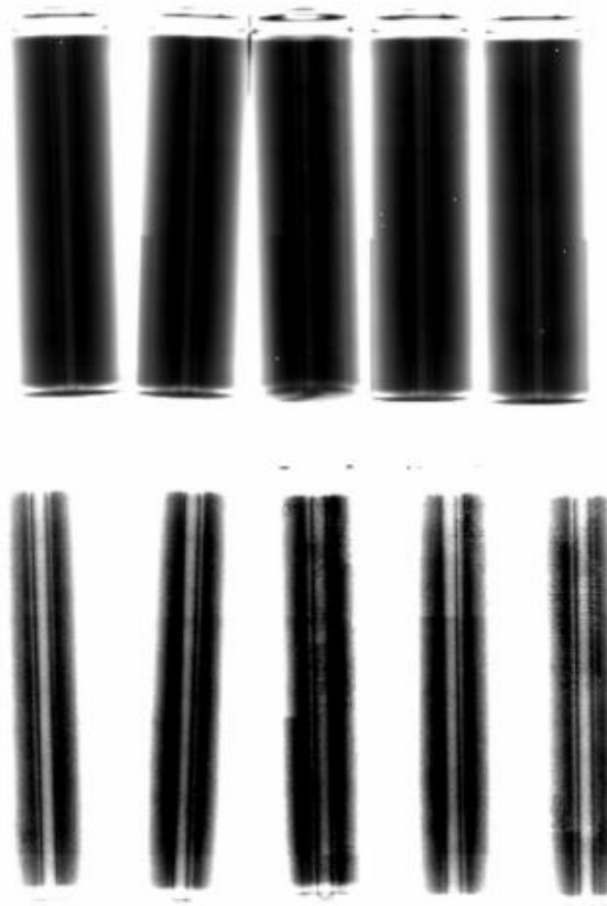
Figura 43 Risultati dell'analisi radiologica delle celle Panasonic
