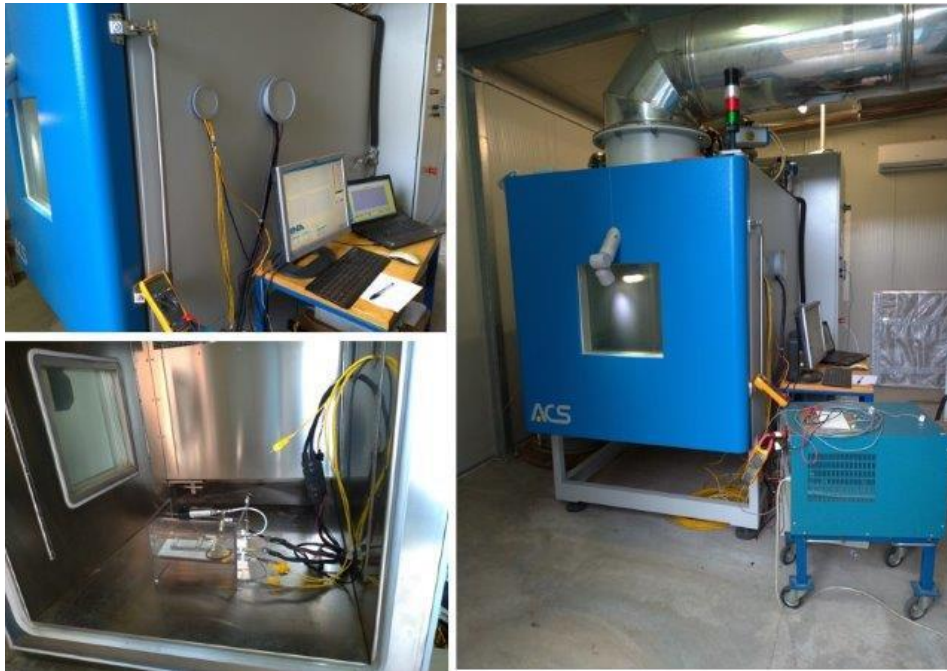
Figura 29 Camera climatica per test di abuso e set-up sperimentale.
