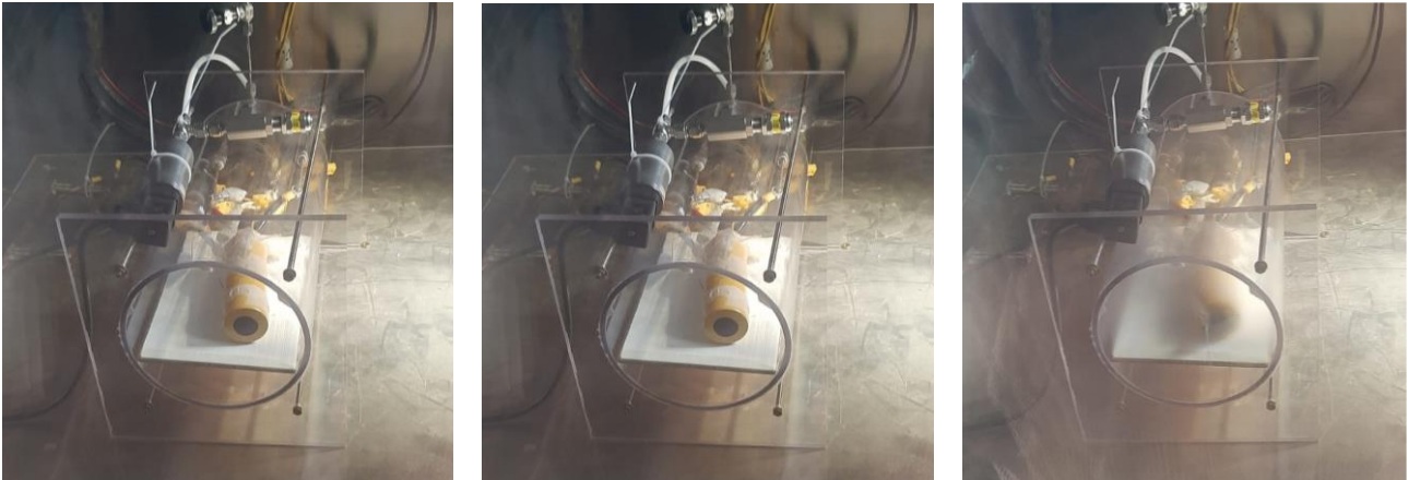
Figura 37 Venting della cella sovraccaricata: cella integra, apertura del fondo, rilascio del gas.
