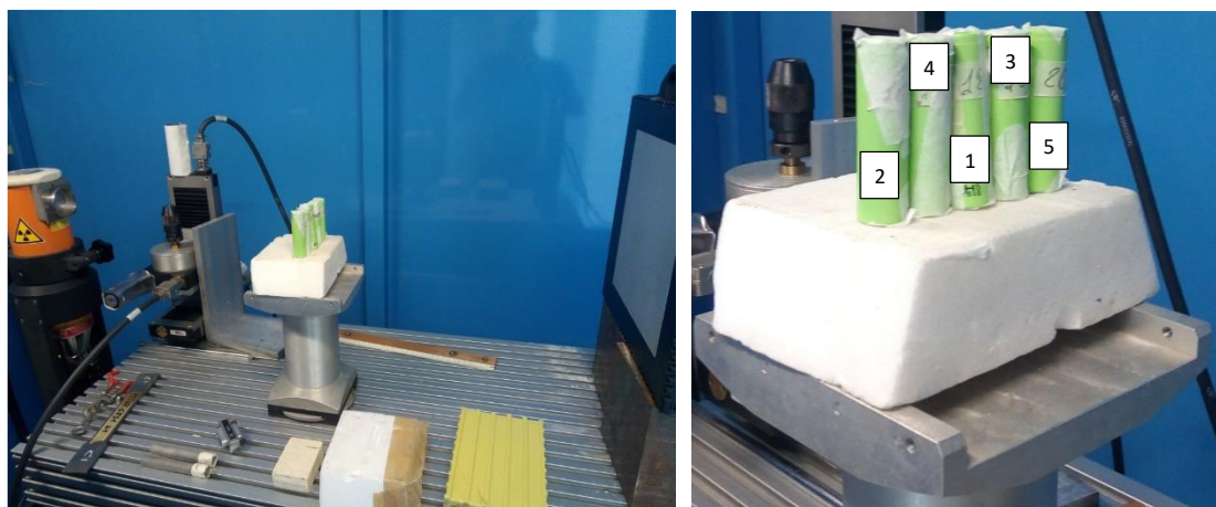
Figura 42 Celle Panasonic sottoposte a controllo radiografico
