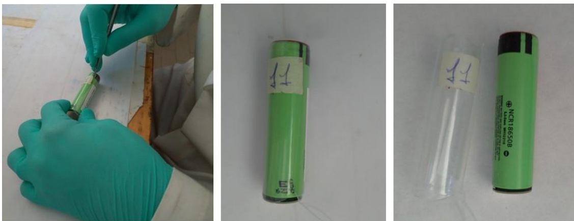
Figura 49 Rimozione della protezione in plastica attorno alla cella
