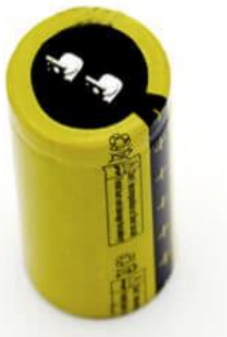
Figura 12 Cella LTO40120 da 10 Ah: collettori di corrente posizionati entrambi nella parte superiore.
