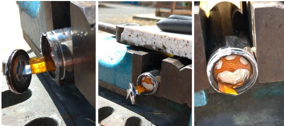
Figura 52 Rimozione del tappo in corrispondenza del catodo
