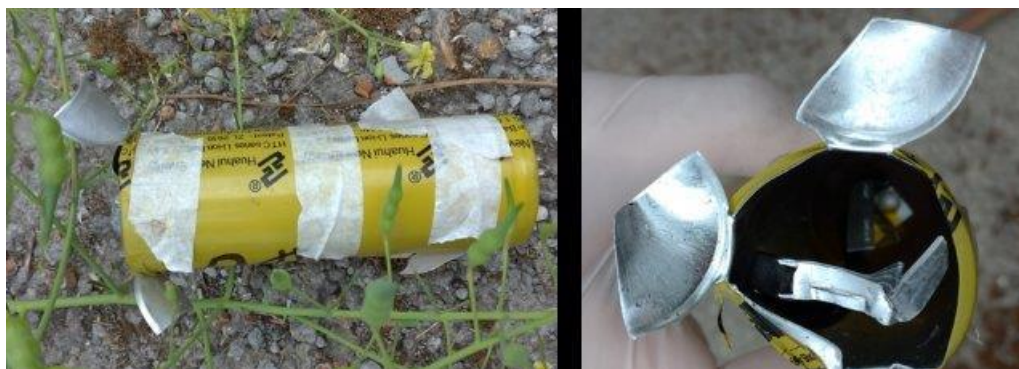
Figura 17 Sovraccarica 1C, Involucro esterno della cella espulso al termine della Fase 1 della sovraccarica
