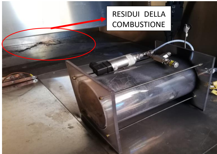
Figura 40 Contenitore dopo il test di sovraccarica con thermal runaway della cella.
