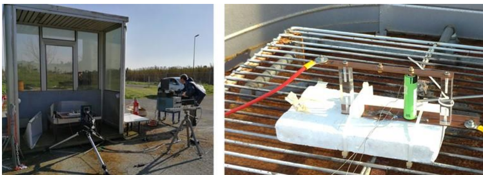
Figura 1 Impianto FARO (a sinistra) e cella (modello NCR18650B) durante il test (a destra)
