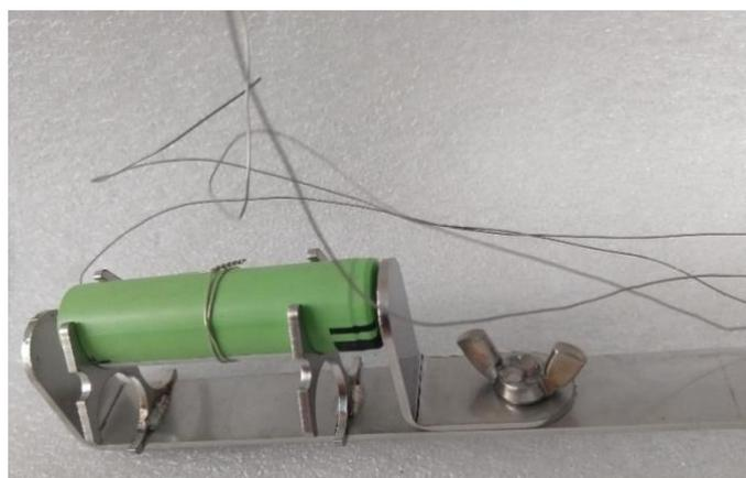
**Figura 20: porta-campione all'interno del reattore**
