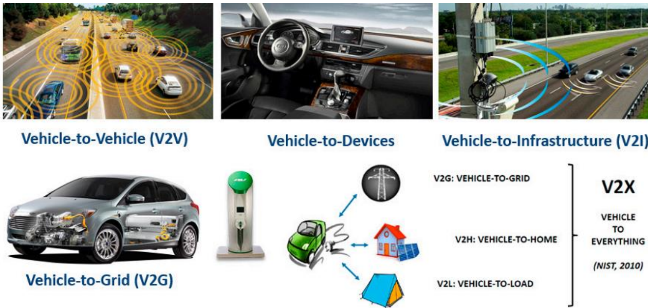
Figura 2: Riassunto delle tecnologie V2X esistenti (Vadi, Bayindir, Colak, & Hossain, 2019)
