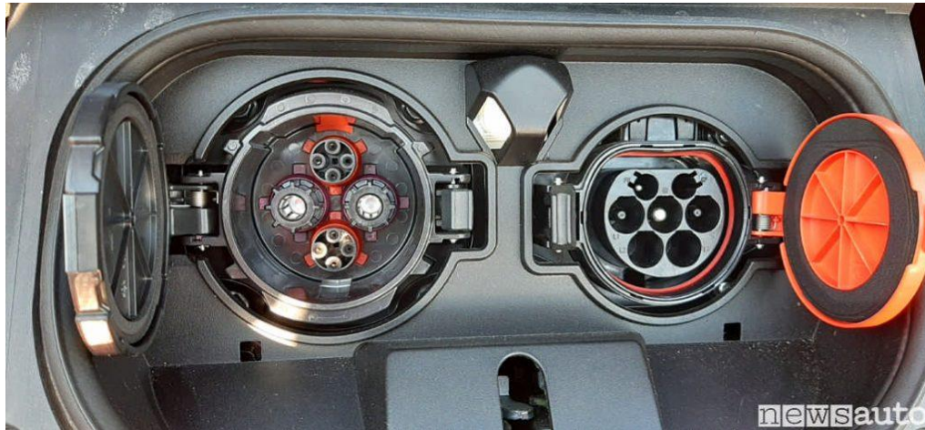
Figura 21: Focus sulle prese di ricarica della Nissan Leaf, CHAdeMO a sinistra e Mennekes a destra
