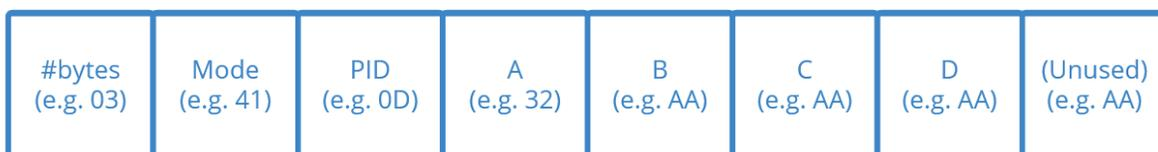
Figura 1 - Struttura del frame OBDII
